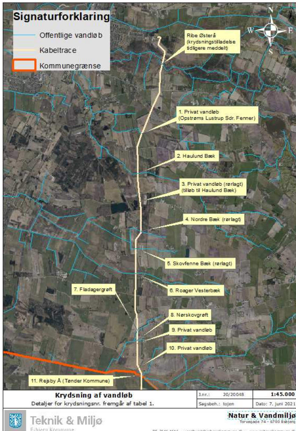
Figur 1. Vandløb der krydses med kabel.
